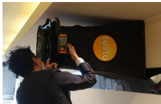
専用機材で風量測定
