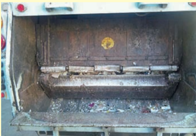
火災が発生した収集車両(消火後)
