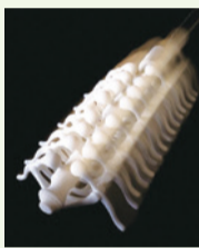
READY TO CRAWL モーター以外の全部品を一体成型して、生物のように完成された状態で生まれたロボット (写真:加藤康)
