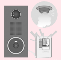
自動火災報知設備
