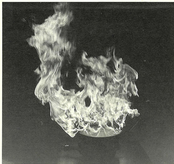
油の温度が上がるにつれて、白っぽい煙が立ち始めます。約14分後に突然発火。炎は最大で2m近くまで上がりました。周囲に布きんなどの燃えやすい物があれば、たちまち火災になるでしょう(注:油の量、コンロの火力など、条件によって発火までの時間は異なります)
