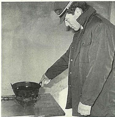
天ぷら油500ccをコンロで加熱 (プロパンガスを使用)
