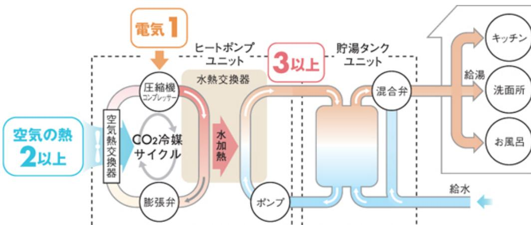
1の電気エネルギー+2以上の空気の熱=得られる給湯エネルギーは3以上
