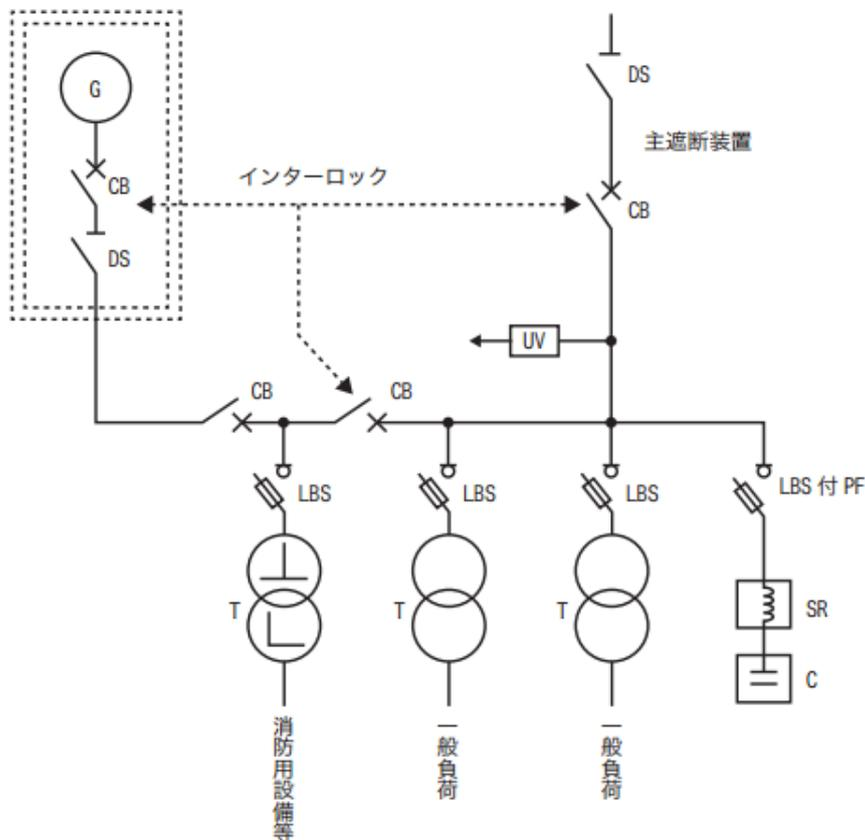
**UV** : 不足電圧継電器等は、主遮断装置の負荷側の位置とし、上位の主遮断装置と適切なインターロックをとること。
