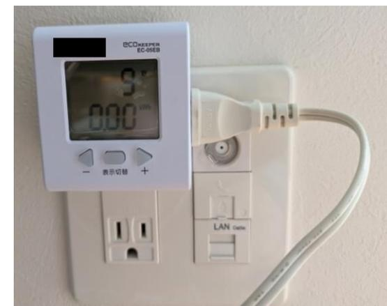
↑ 機器とコンセントの間にはさむように使用すると消費電力を計測できる。
