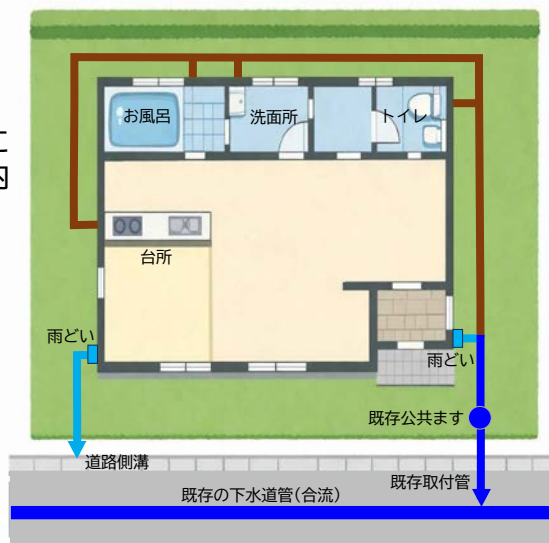
図) 私有地内の排水設備(排水管)の例
