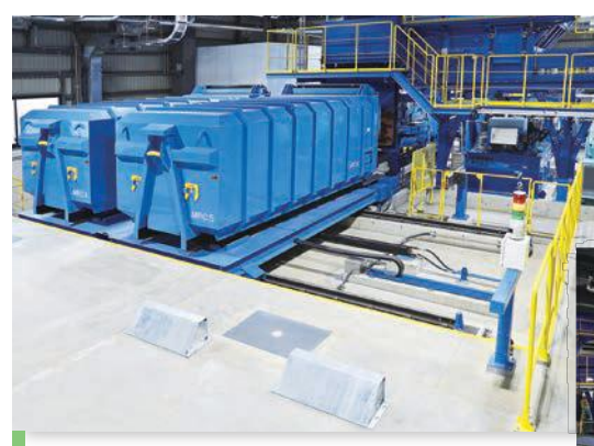
コンテナ移動装置 コンテナを一時貯留し、空コンテナと満杯のコンテナの入れ替えをスムーズに行います。
