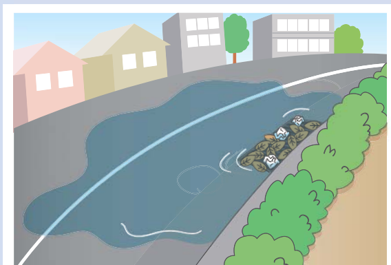
おおあめ 大雨が降ったとき、道路の側溝にゴミなどが詰まり、排水されずに道路が冠水します。
