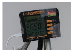
CO<sub>2</sub>モニターでCO<sub>2</sub>濃度を計測
