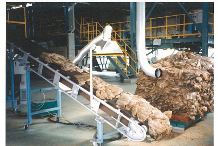
⑮ 農業用廃ビニール（原料）の投入
