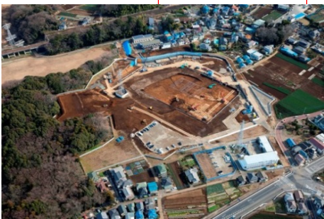
根切り工事 土を掘削した様子
