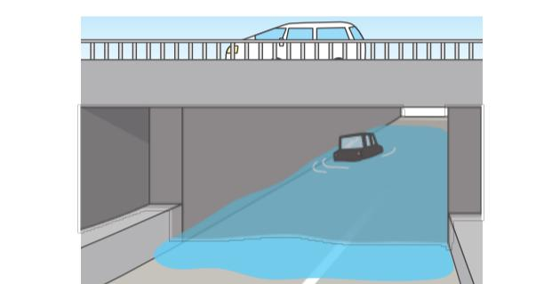
下大雨时,道路旁边的排水沟被垃圾等堵塞,无法排水,道路将被水淹。
