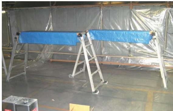
図 4.7.57 可搬式作業台の例
