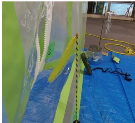
図 4.14.11 吹き流しによる確認
