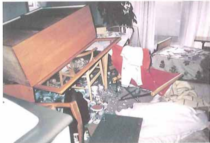
多くの住宅で食器棚や冷蔵庫が倒れ、扉が開いて中のものが散乱。食器などの破片で室内が危険な状態となった
