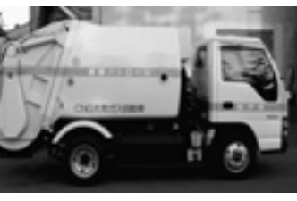
天然ガスエネルギーのごみ収集車
