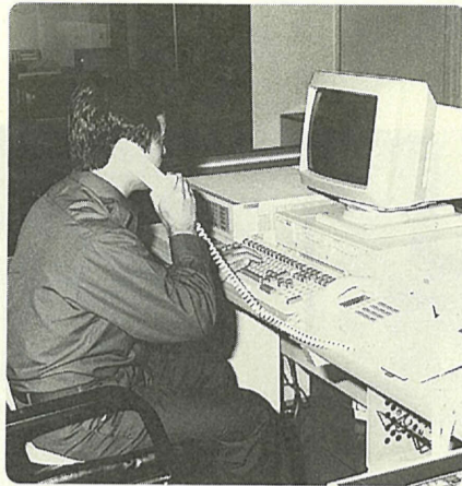
消防局では通報が入ると、相手が話をできない状態でも、自動的に相手の情報が画面に表示されます
