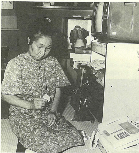
電話機本体やハンダントのボタンを押すと消防局の通信指令室へつながり、受話機を取らなくても話ができます(ガス漏れや火災の時には自動通報されます)
