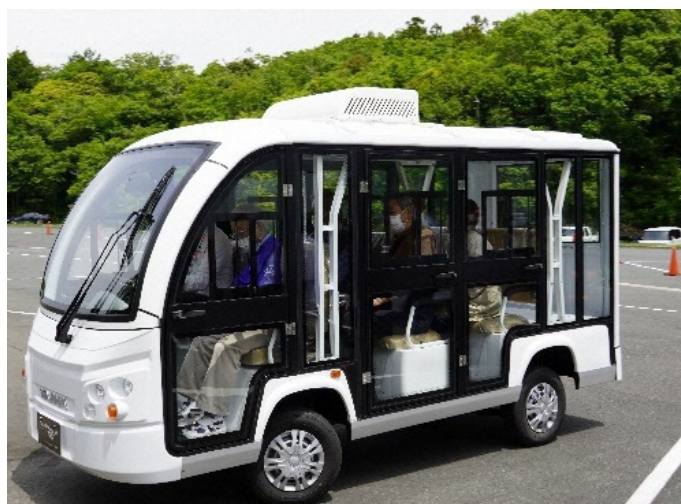
▲松戸市で導入するグリーンスローモビリティ車両 (株)タジマモーターコーポレーション製 TAJIMA-NAO-6J(8人乗り)
